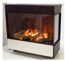
Der "3-side 3D Elektrofeuereinsatz" kann in x-beliebige Kaminumbauten integriert werden. Dieses Einbaumodul mit 3-dimensionalen Elektrofeuer kann wahlweise als 3-seitiger, 2-seitiger oder I-seitiger Kamin eingebaut werden (mit und ohne Verglasung). Der Flammeneffekt wird per Ultraschallvernebelung, durch beleuchteten Wasserdampf erzeugt. Mit auswechselbaren Lampen ausgestattet, wird ein sehr schöner Kaminfeuer-effekt auf größerer Breite realisiert.
